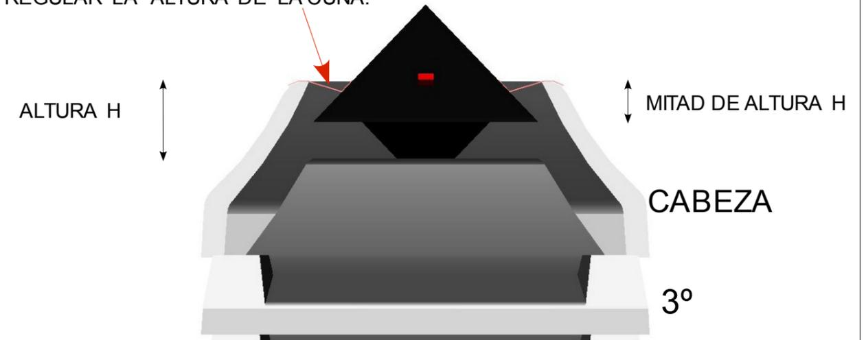
CUÑA DEFLECTORA DEBE QUEDAR CENTRADA CON EL 3° ELEMENTO DEL SOMBRERETE Y FIJA A LA CABEZA MEDIANTE LAS OREJAS DE LA CUÑA VINCULADAS POR MEDIO DE TORNILLOS-TARUGOS.
